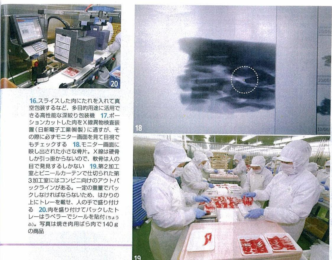
16.スライスした肉にたれを入れて真空包装するなど、多目的用途に活用できる高性能な深絞り包装機 17.ポーションカットした肉をX線異物検査装置(日新電子工業製)に通すが、その際に必ずモニター画面を見て目視でもチェックする 18.モニター画面に映し出された小さな骨片。X線は硬骨しか引っ掛からないので、軟骨は人の目で発見するしかない 19.第2加工室とビニールカーテンで仕切られた第3加工室にはコンビニ向けのアウトパックラインがある。一定の重量でパックしなければならないため、ばかりの上にトレーを載せ、人の手で盛り付ける 20.肉を盛り付けてパックしたトレーはラベラーでシールを貼付(ちょうど)。写真は焼き肉用ばら肉で140gの商品
