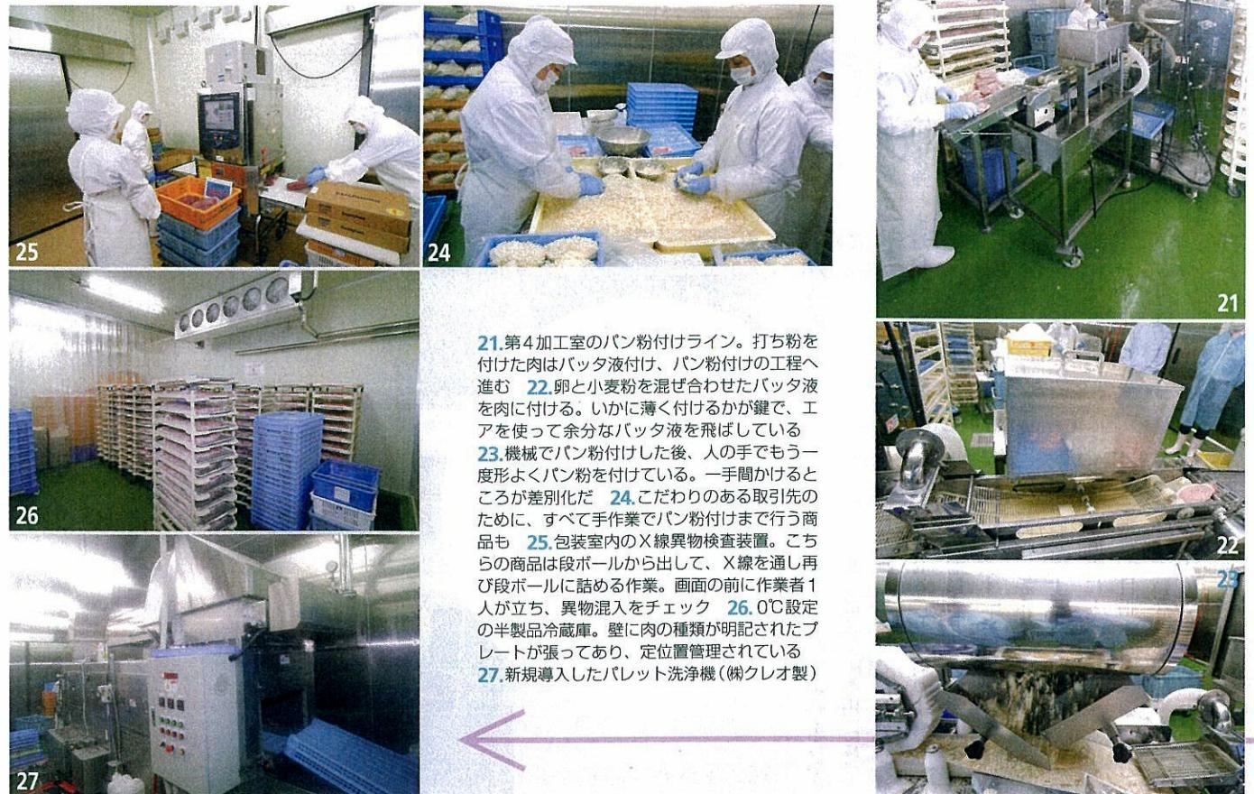
21.第4加工室のパン粉付けライン。打ち粉を付けた肉はバッタ液付け、パン粉付けの工程へ進む 22.卵と小麦粉を混ぜ合わせたバッタ液を肉に付ける。いかに薄く付けるかが鍵で、工アを使って余分なバッタ液を飛ばしている
