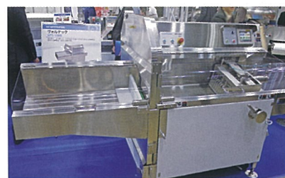
▲最新の食肉加工機械も多数展示された。ワタナベフマック株（本社：名古屋）では、1分間に380回の処理能力をもち、女性でもラクに操作できるチョップカッター「ヴォルテック」を展示（写真左） 株小野尚事（本社：千葉県）は骨片やスジを自動的に分離するドイツ製ミートチョッパーの実演を行った
